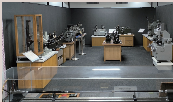
写真2 ずらりと並んだ万能測長機
