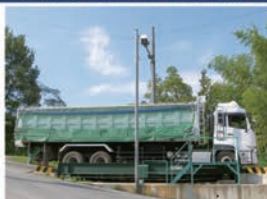
積載車両入庫時、停車して約20秒計測
