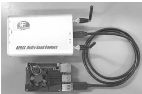
図3 音の取得とAIによる異常検出装置
