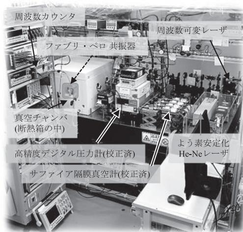
図6 光学式圧力標準の外観
