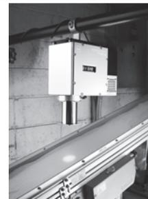
非破壊・非接触のインライン型近赤外水分計製造ライン上をリアルタイムで水分測定 防水防塵保護等級 IP66 適合 無塗装で錆や塗膜剥がれのライン混入なし 食品や薬品、土木など幅広い分野で活用
