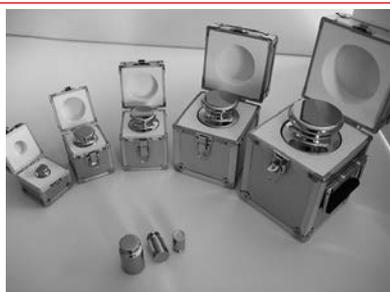
国際法定計量機関 (OIML) が発行する分銅に関する国際勧告 (R111) の技術要求事項に準拠した分銅です。特に、E 級クラス分銅には、腐食性、摩耗等に優れた非磁性ステンレス鋼を使用しており検査、校正等の社内質量標準として最適です。
