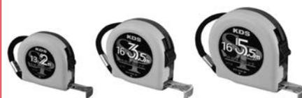
ムラテック KDS 独自の「特級」規格、「長さ許容差 = ± 0.2mm 以内」に準拠した引っかけ測定専用高精度コンベックスです。個体差による測定のばらつきを最小限に抑えられ、社内校正用基準器にも適しています。ラインナップは、2m と 3.5m、5.5m の 3 種で、全て独自の長さ検査証付です。
