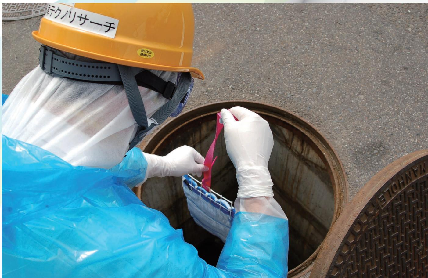
下水モニタリングのサンプリング作業
