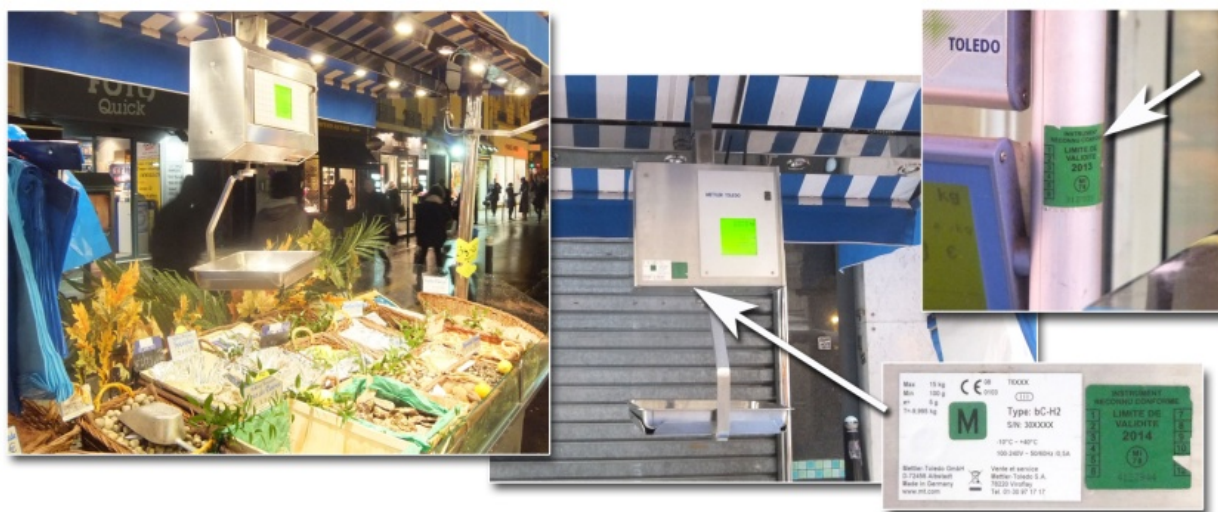
写真 12: フランスの市場で使われているはかりと検定ラベル (緑色) の例
